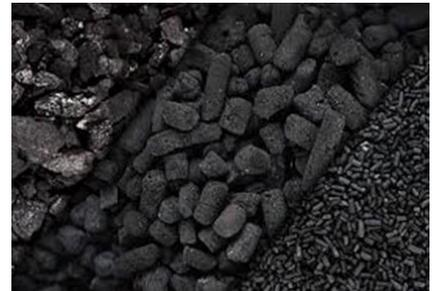
Dentro da melhor técnica de deposição química cerca de 6% em peso de Sódio estão perfeitamente distribuídos sobre uma superfície efetiva mínima de 900 m<sup>2</sup>/g do suporte catalítico, o que resultará em uma rápida reação dos compostos de Enxofre, formando p.ex. Sulfeto de Sódio, que permanecerá retido dentro dos poros do Carvão Ativado Granulado. Esta mesma característica também pode acontecer com a retenção dos ácidos inorgânicos em fase gasosa.
