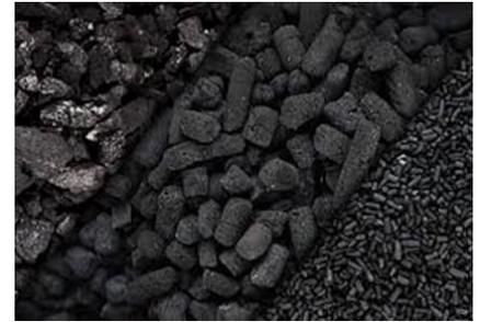
O CARBOZAR-77 está impregnado com compostos metálicos, principalmente de Fósforo, tecnicamente depositado sobre a superfície interna dos poros de Carvão Ativado, o qual é utilizado como suporte catalítico.
