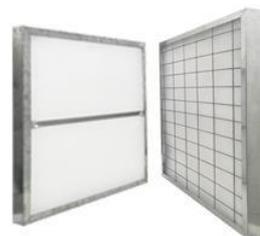
O **Filtro Porta Manta (Porta Filtros) ZANIFIL** é composto por moldura de aço galvanizado PERMANENTE e uma tela de sustentação na saída do ar (Temos nas opções inox ou alumínio, sob consulta). São indicados para filtragem de ar e substituem os filtros descartáveis com moldura de papelão, garantindo economia e custos operacionais de manutenção e descarte, já que a troca é somente do elemento filtrante após sua saturação.
