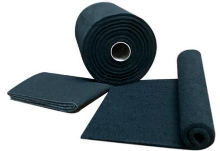
A CARBOFIZ é considerada uma manta de poliéster agulhada que pode atender até a classe de filtragem F8 de acordo com a ABNT NBR 16401, fornecida em rolo com tubete de papelão com medida interna D=60mm, larguras de 140, 145, 250, 500, 1000 e 1200mm, com comprimento de 100 ou 200 metros e espessura de 0,5mm.
